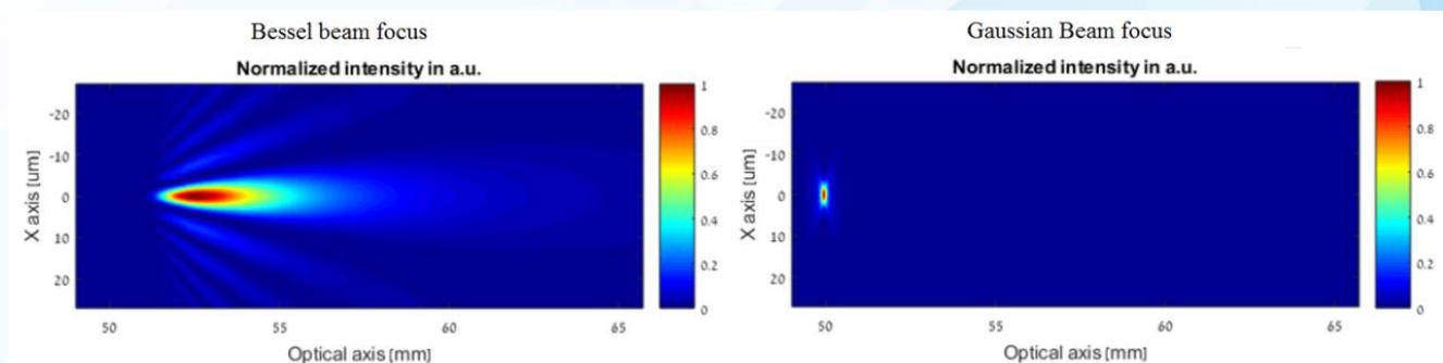
图 2: 与仅聚焦高斯光束相比, 使用衍射轴棱锥生成贝塞尔光束可以提供更大的焦点深度。
